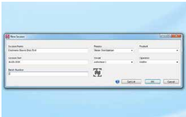
Coloque o dispositivo de medição SteriSense na Estação de Leitura e abra o software SteriSense. Defina o Nome da Sessão.
